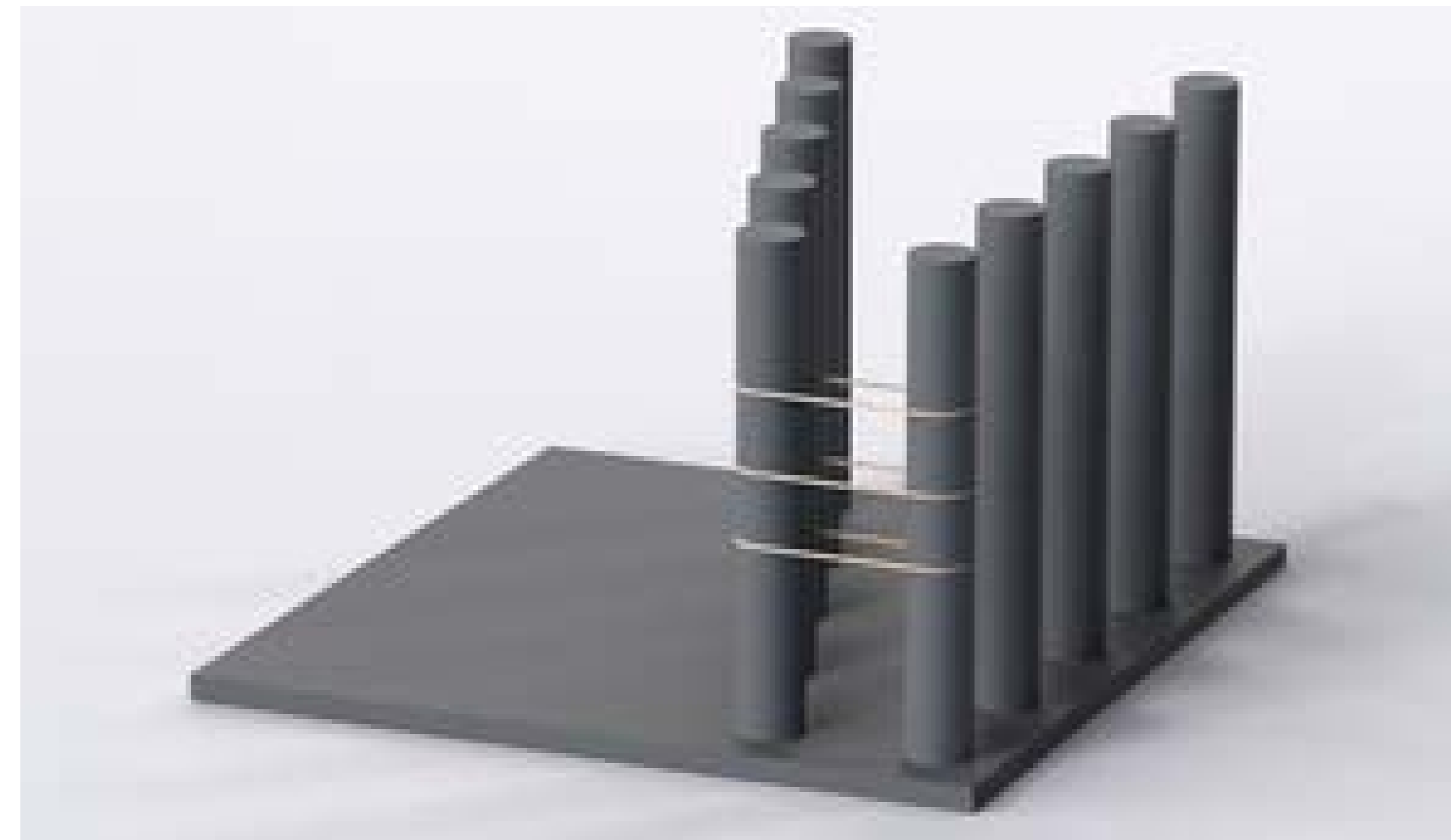
obr. 1 - 3D model sloužící na konstantní natáhnutí intermaxilárních tahů
