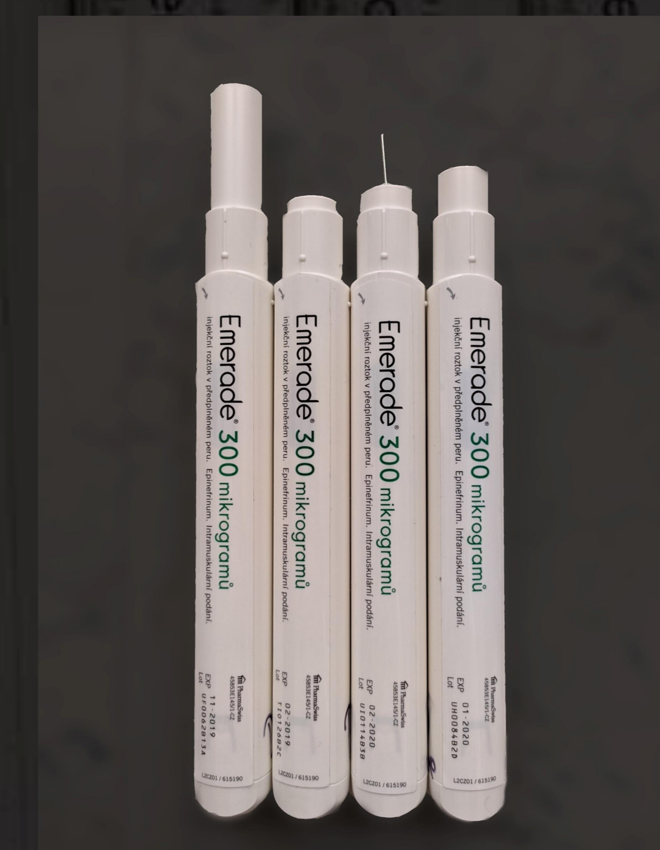
Obr. 4 Emerade po pádu zleva: vystřelený; zaseknutý; vystřelený s odkrytou jehlou, připravený k použití
