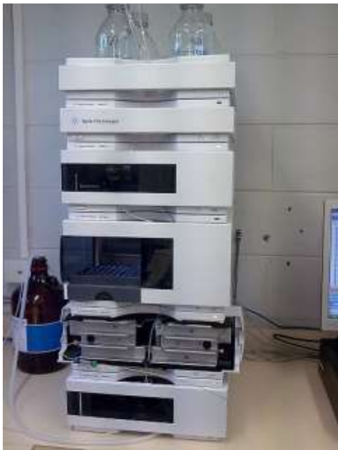
Obrázek 1 HPLC - přístroj k přesnému měření množství určité látky
